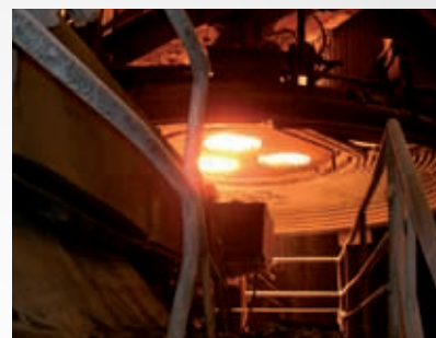
Forni elettrici ad arco
