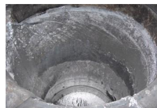
CPS® da 7,5 t. dopo 7 mesi di esercizio.
