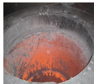
CPS® da 7,5 t. dopo 2 mesi di esercizio.
